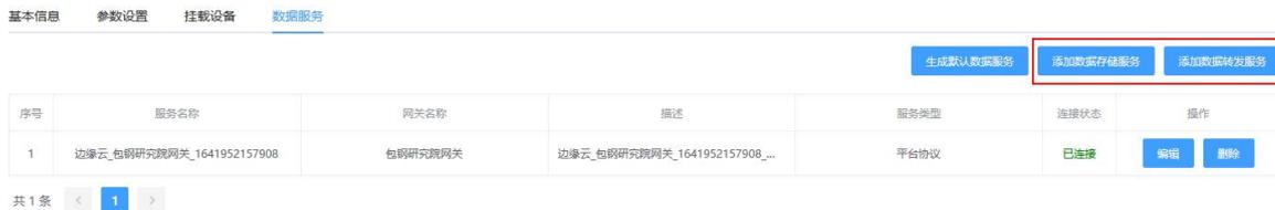
添加数据存储服务，需要配置服务名称、服务描述、选择协议，根据协议进行配置参数，选择需要存储的设备数据。配置完成后，点击“保存”按钮。
