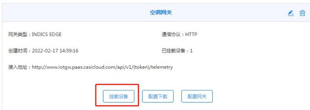
在弹出框中，点击左侧设备树，将已创建好的设备，添加至该网关下，点击“确定”完成设备与网关的绑定操作。
